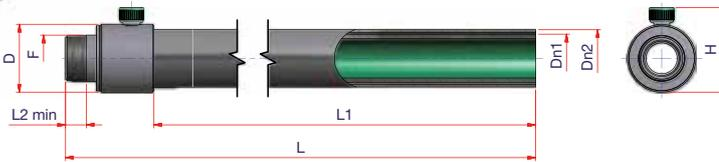
ADAPTATEUR MÂLE LONG DOUBLE PAROI AVEC PRISE DE TEST
