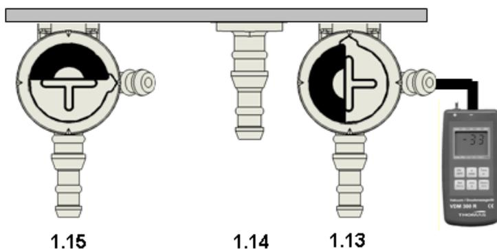
Geeignetes Prüfgerät (z.B. Thomas VDM300) an das Prüfventil der Messleitung (1.13) anschließen, Verbindung zum Messgerät durch Drehen des Ventilkopfes herstellen.
