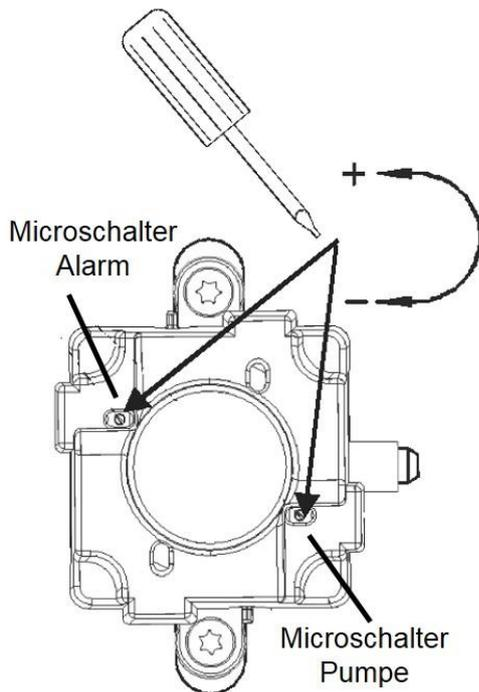
**Prüfung der Einstellwerte** des Leckanzeigers (siehe *Kapitel 6.3 Werksseitige Einstellung der Schaltwerte „Alarm Ein“  $P_{AE}$  und „Pumpe Aus“  $P_{PA}$ .*
