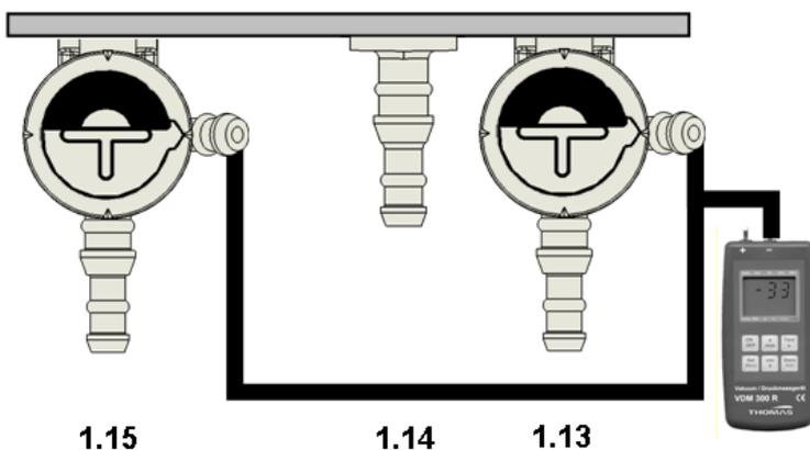
In der dargestellten Stellung kann der Überwachungsraum (12) ohne Leckanzeiger geprüft werden, z.B. auf Dichtigkeit.
