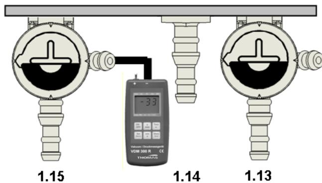
Durch Anschluss des Messgerätes am Prüfventil der Saugleitung (1.15) kann in der links dargestellten Stellung der maximale Unterdruck der Pumpe überprüft werden.
